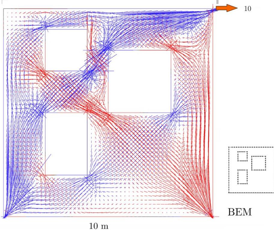
Scheibe mit Einzelkraft (oben rechts) Hauptspannungen finite Elemente  $0.2 \times 0.2$  m (SOFiSTiK) und Randelemente, Raster der Ergebnispunkte  $0.2 \times 0.2$  m (BE-SCHEIBE). Die Ergebnispunkte der FEM sind die Mittelpunkte der (leicht), unegal' geschnittenen Elemente, während sie bei der BEM streng im Raster liegen, 'auf Linie'.
